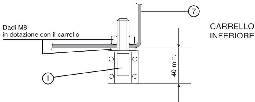
FISSARE LA GUIDA SUPERIORE (6) MEDIANTE LE VITI (D), I DADI (E) E LE RONDELLE (F) (N° 3 PER OGNI GUIDA) IN CORRISPONDENZA DELLA GUIDA INFERIORE (5) NELLA POSIZIONE INDICATA NEL DISEGNO:
