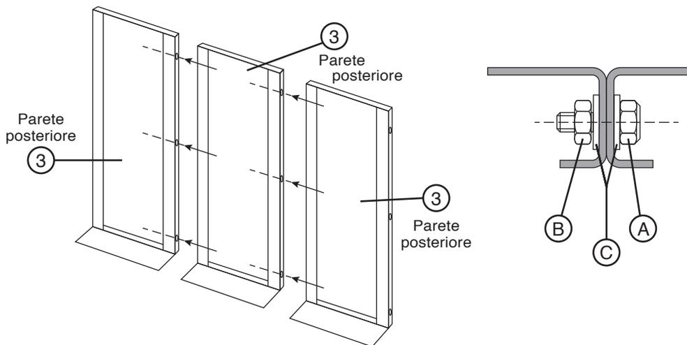
FISSARE I DUE DISTANZIALI (SUPERIORE E INFERIORE) (2) MEDIANTE VITI (A) E RONDELLE (C) COME SOTTO INDICATO.
